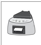
**3|** Cierre la cubierta de la impresora presionando en los lados de la tapa.
