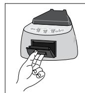
**1** Para sustituir el rollo de papel, tire de la manija de la tapa de la impresora. Abra la tapa y retire el rollo vacío.
