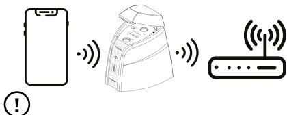
Si la Auto-lectora no aparece en su dispositivo móvil, siga los pasos detallados en la sección: *Habilitando la conectividad Wi-Fi de la Auto-lectora*. Esto creará una nueva red Wi-Fi interna.
